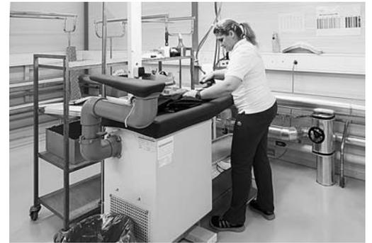
Fig. 5: Altezza di lavoro adeguata alla statura durante la stiratura. Predisporre l'alimentazione di corrente dall'alto e una superficie di appoggio sicura per i ferri da stiro caldi.
