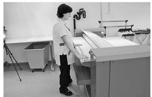
Fig. 3: Mangano con protezione per dita e mani. La macchina si arresta non appena si entra in contatto con il dispositivo di protezione.
