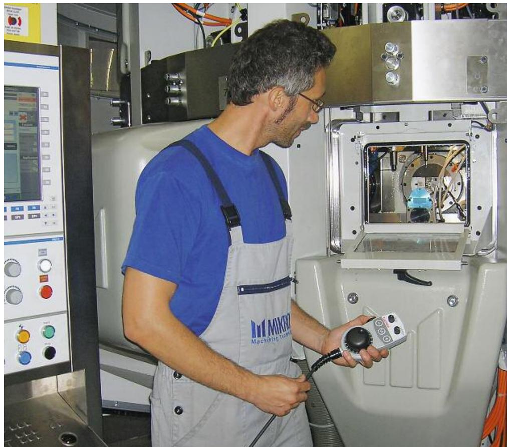
Handterminal mit dreilagiger Zustimmungseinrichtung. Rundtaktautomat NRG-50 der Firma Mikron SA in Agno TI.
