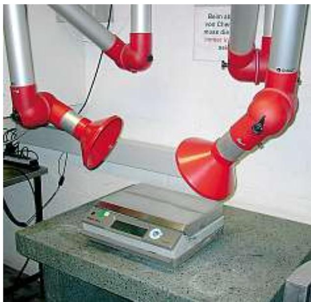
Waage mit Quellabsaugung
